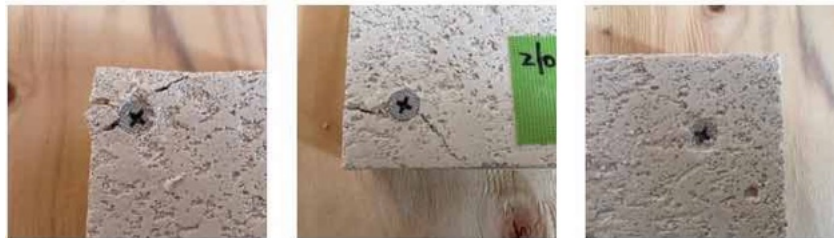
図5 ボードビスの留付確認
